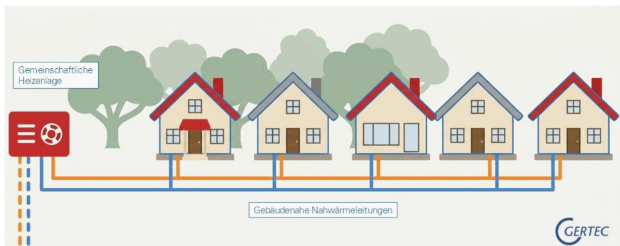
Abbildung 49 Schematische Darstellung der Konzeption „Nachbarschaftswärme“
